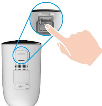
Si la cámara se queda sin batería, conéctela al toma de corriente con el adaptador de corriente para cargarla (5V 2A).
